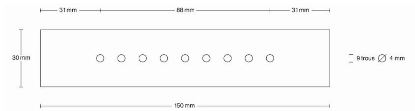
Trous centrés en hauteur et en largeur : 11 mm entre chaque axe de perçage
